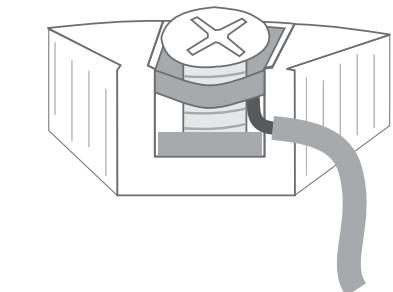
Die Leitungen müssen zwischen den Metallplatten montiert werden.
