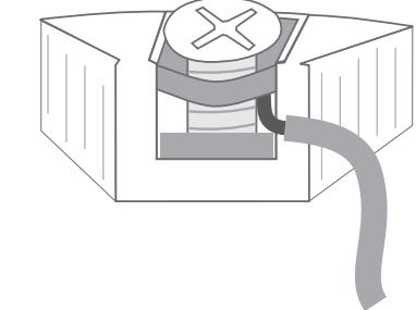
Les fils doivent être montés entre les plaques métalliques.
